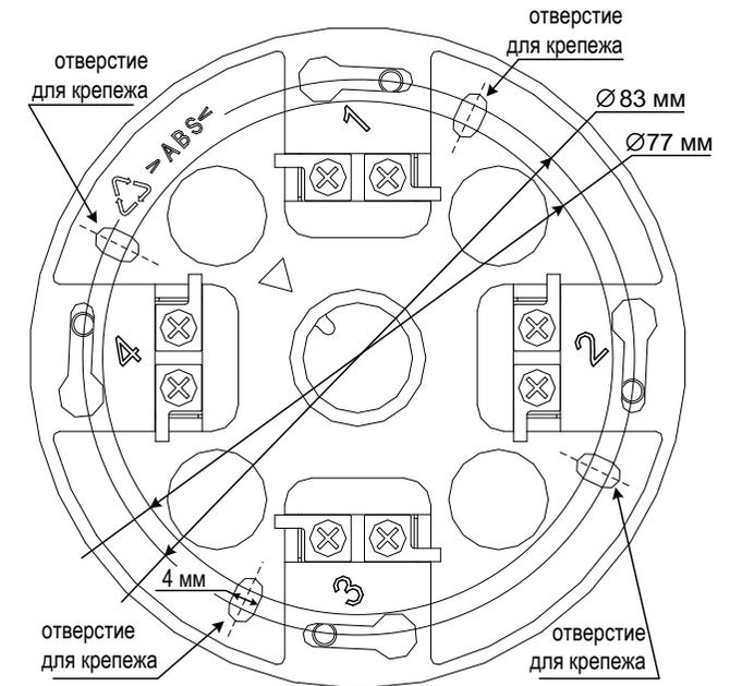
**Рис.4** Базовое основание извещателя. Расположение отверстий для крепежа.
